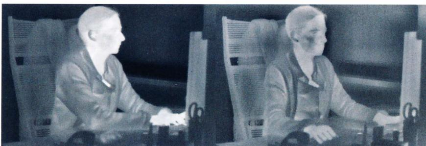
**Bei der Auswahl eines Wärmebildgeräts kommt es nicht allein auf die technischen Hard Facts, wie Sensorauflösung oder Pixelgröße, an, sondern auch auf die gewünschten Bildrepräsentationen, die sehr unterschiedlich bei den Herstellern ausfallen können. Im linken Bild werden warme Bereiche sehr hell und dominant dargestellt, während diese Regionen im rechten Bild eher zurückgenommen sind. Es lassen sich so mehr Strukturen im Gesicht oder dem Stuhl im Hintergrund erkennen.**
