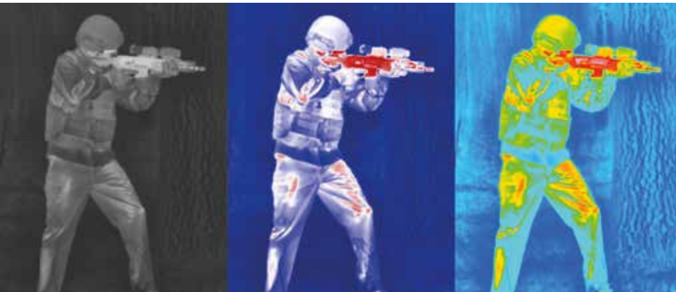
Bei identischen technischen Daten kann durch unterschiedliche Bildrepräsentationen – z. B. mit Falschfarbendarstellung – das Augenmerk auf spezifische Temperaturbereiche bzw. Objekte gelenkt werden
