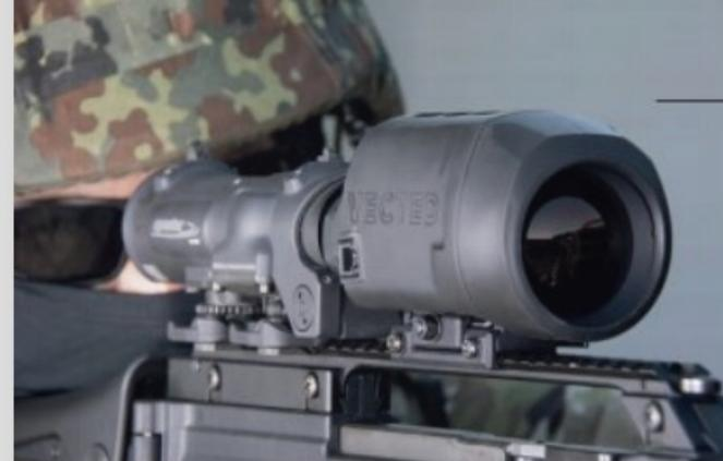
Sensoraufklärung ist auch die Pixelgröße relevant; die Pixel werden immer kleiner und empfindlicher: 12 µm sind bei der 640er Serie Standard. Der technische Vorteil: Bei gleicher Gerätegröße kann die Einsatzreichweite etwas vergrößert werden, allerdings zu Lasten des Bildfelds, das etwas geringer ausfällt.
